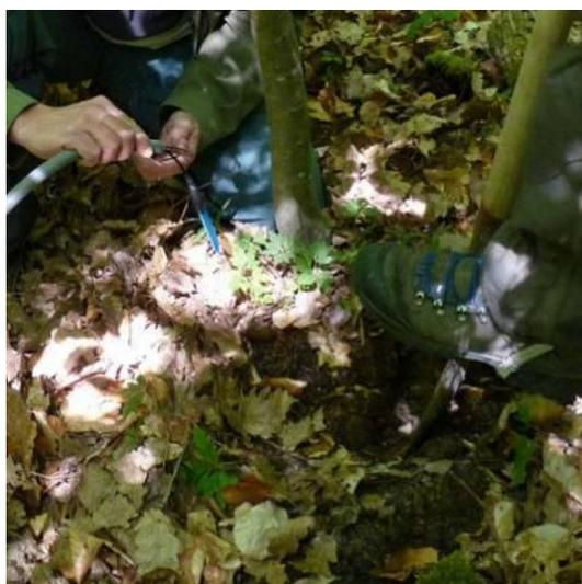
Photographie 4 : Mise en place des sondes de mesure de la teneur en eau du sol à une profondeur de -20 cm.
