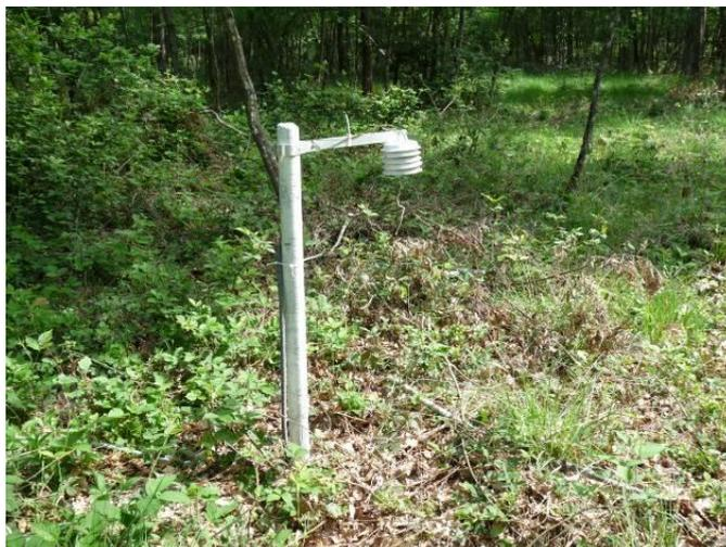
Photographie 5 : Mesure de la température de l'air sous abri.
