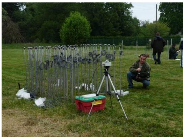
Photographie 3 : Etalonnage de l'ensemble des capteurs + capteur BF5 au premier plan.
