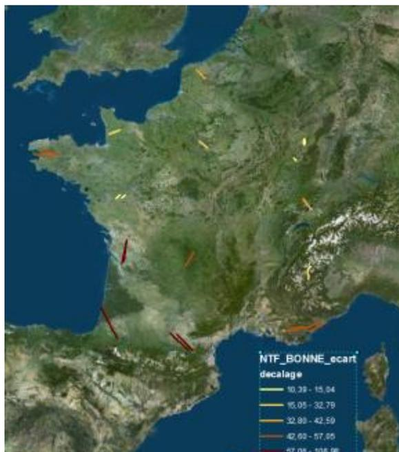
Figure 21 : matérialisation des vecteurs d'écart France entière entre le système ATIG et NTF - accentués 1000 fois- un écart de 10m est représenté par un segment de 10km sur la carte
