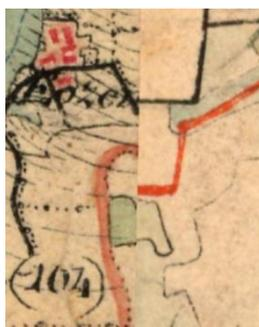
Figure 69 : (à gauche) exemple d'un décalage d'une limite administrative où un tronçon FICTIF = vrai est nécessaire pour assurer la continuité.
