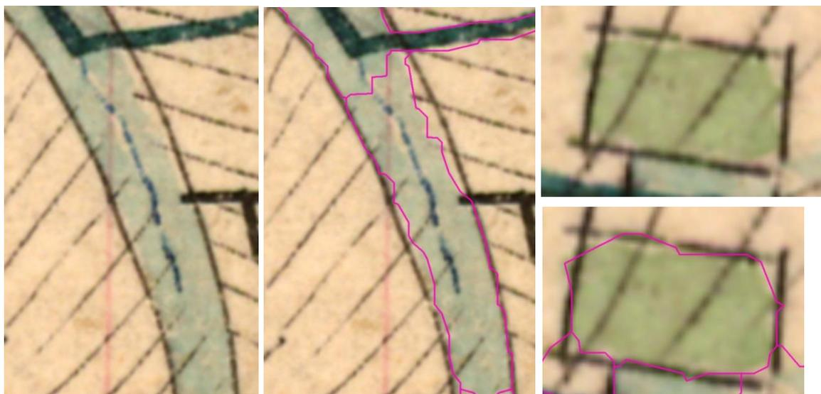
**Figure 67** : Si la segmentation est utilisée pour la saisie, alors il faut revoir la conception de saisie, dans le sens où les limites suivent la teinte de couleur et non la limite artificielle matérialisée (trait noir). Il existe des outils simples de correction de la géométrie sous ArcMap® (remodelage par exemple).
