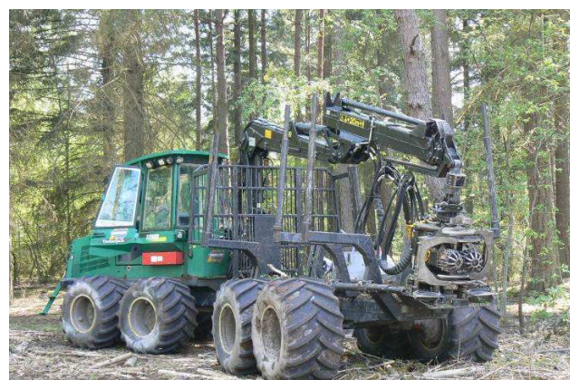
Machine combinée : abatteuse à pince ou cisaille sur porteur - Photos R. Grovel
