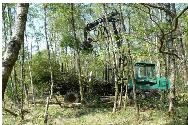
Machine combinée : abatteuse à pince ou cisaille sur porteur - Photos R. Grovel
