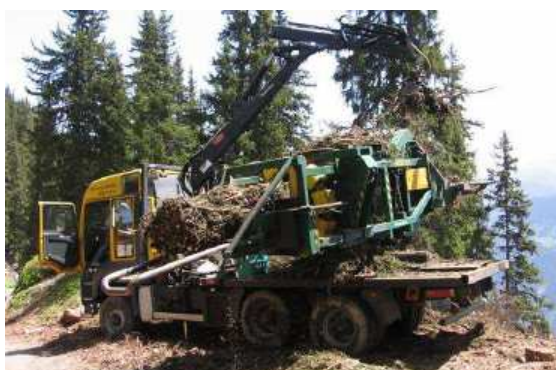
Fagoteuse montée sur camion 6x6 – Von Atzigen CH Source : ONF
