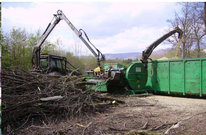
Déchiquetage de houppiers feuillus sur place de dépôt. Photo D. Barthelet
