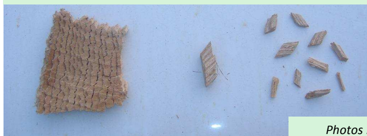
Tranche, décollage des cernes et fragmentation des plaquettes
