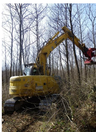
Cisaille type sécateur sur pelle mécanique à chenille Photos R. Grovel
