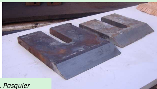
Couteaux amovibles pour déchiqueteuse à tambour
