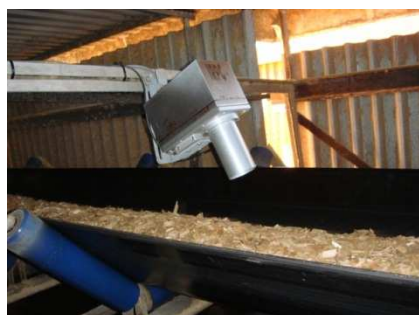
Système infra-rouge de mesure d'humidité sur tapis roulant de plaquettes de bois (photo : EDIT PC). Adapté aux grosses unités en alimentation continue.
