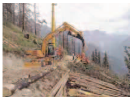
Débardage arbre entier au câble mât et façonnage par tête d'ébranchage montée sur une pelle à pneus
