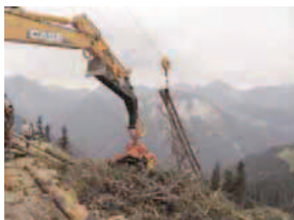
Débardage arbre entier au câble mât et façonnage par tête d'ébranchage montée sur une pelle à pneus
